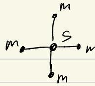
每个 spin 感受到邻居的有效磁场  $B_{\text{eff}} = B + Jq\langle m \rangle$  ← Mean field 名字来源
