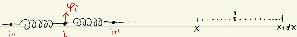
$N$  个质点用全同弹簧相连. 弹性系数为  $k$ ,  $\varphi_i$  为第  $i$  个质点对平衡位置  $o$  的偏离,  $a$  是质点平衡距离.
